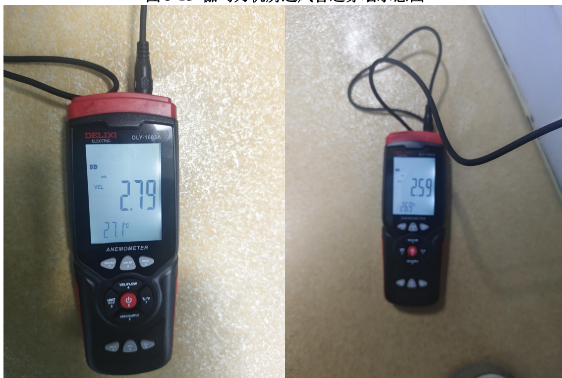
图 3-16 伽玛刀机房排风检测照片
